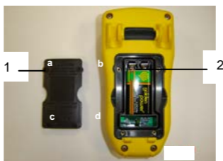
Figura 6 : accesso alla pila
