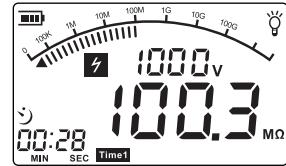
5. 时间满30秒后仪器自动结束测量，高压警报“滴、嘀”声消失，测量结束。此时LCD屏幕显示如下图：
