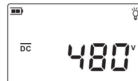
测直流电压红表笔接“-”，黑表笔接“+”时，LCD屏幕显示如下图：
