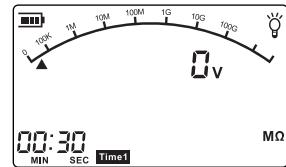
4. 按下“”按钮，此时仪器开始进入定时测量状态，蜂鸣器间歇地发出“滴、嘀”声，定时“Time1”闪烁，测试过程中LCD屏幕显示如下图：
