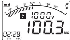
4. 测试完毕后，按下 “
