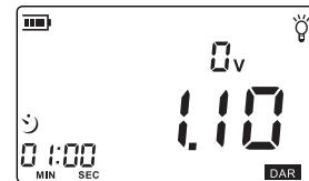
4. 在设定时间TIME2结束测量后，高压警报“嘀、嘀”声消失，并且比率：在TIME2的绝缘阻抗÷在TIME1的绝缘阻抗将显示在LCD屏幕上，如下图：
