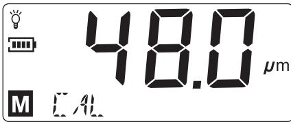
选择厚度在45~55间的标准片，按“▲”或“▼”键修改其显示值，使显示值与标准片的标称厚度一致，再将标准片放在铁基上进行校准。
