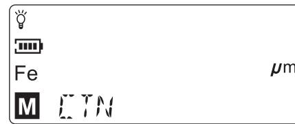
➤ 将探头置于被测件，轻压探头且不提起探头进行测量，测量过程中不响声，LCD屏幕连续显示测量结果，直至提起探头后，最后一个测量值自动记录于本机中，记录数据个数同时显示1，（当第二次连续测量结束时，测量个数则自动升级为2，以此类推，直到测量个数满15时，则不再递增），此时LCD屏幕显示如下图所示：
