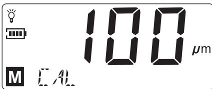
选择厚度在95~105间的标准片，按“▲”和“▼”键修改显示值，使显示值与标准片的标称厚度一致，再将标准片放在铁基上进行校准。
