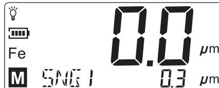
c. 要准确地校准零点，须重复上述a、b以获得基体测量值小于 $1\mu\text{m}$ ，这样有利于提高测量精度。
