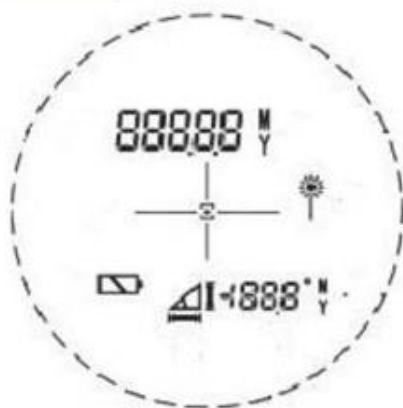
图2 镜内LCD全显图符说明
