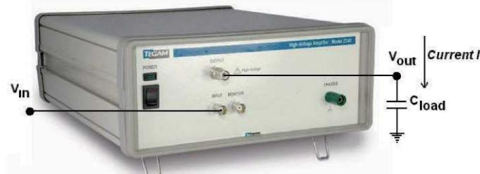
上图：容性负载，在电压放大器的输出端，
