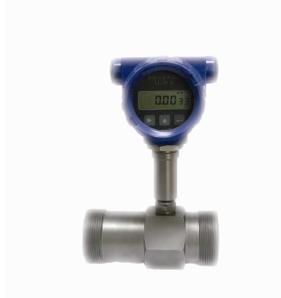
LWGYB 型涡轮流量计，是在涡轮流量传感器的基础上，增加了电池供电的现场 LCD 显示表头。该显示表是采用先进的超低功耗单片微机技术研制的，传感器与显示表组成一体型涡轮流量计。与传统的涡轮流量传感器配二次仪表组成的测量系统相比，它具有体积小、重量轻、显示读数直观、清晰、可靠性高等明显优点。表头显示方式单排 7 位液晶显示，自动切换显示瞬时流量和累计流量。也可单独显示瞬时流量或累计流量，低功耗工作：一节锂电池可连续使用 3 年以上，掉电保护仪表系数、累计流量值保持十年不丢。
