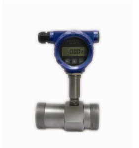
LWGYC 型涡轮流量传感器是在 LWGYB 型涡轮流量计的基础上增加了 4~20mA 两线制电流变送功能，该仪表需要 24VDC 供电，即可现场显示又可远传输出，特别适合于与显示仪、工控机、DCS 等计算机控制系统配合使用。
