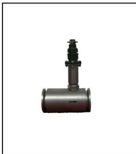
涡轮流量传感器本身不具备现场显示功能，仅将流量信号以三线制电压脉冲的形式远传输出。供电电源+12VDC 或+24VDC，远传距离 250m。仪表价格低廉，集成度高，体积小巧，特别适用于与二次显示仪等计算机控制系统配合使用。
