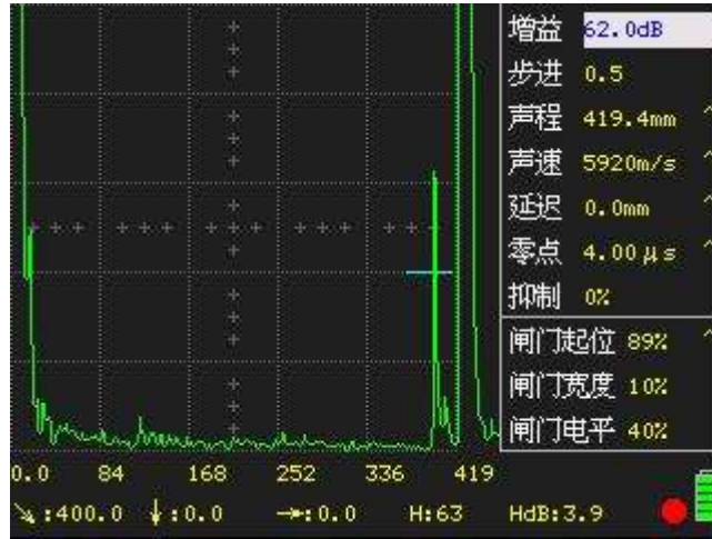
(图示为 400mm \Phi 2 平底孔锻件试块的回波)
