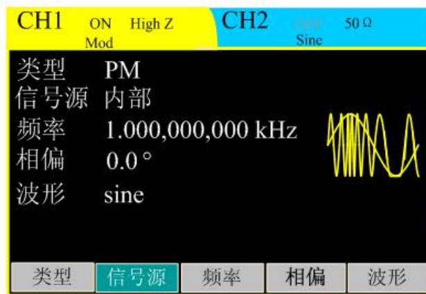
图 2-23 相位调制波形参数设置界面 表 2-14 设置相位调制参数的菜单说明
