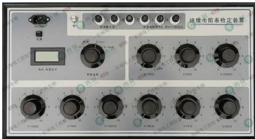
2)、面板上部分字符说明：在 U 档可测开路电压 (U<sub>k</sub>)、中值电压 (U<sub>Z</sub>)、跌落电压 (U<sub>d</sub>)、U<sub>f</sub> 档可测峰值电压、
