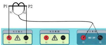
④ CT升流保持 (使用内置电源) 测量方案 1
