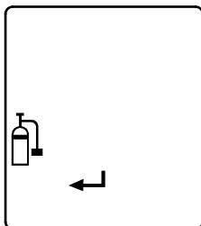
仪器标定气体的浓度是固定的。您必须用含有  $25\mu\text{mol/mol(ppm)}$   $\text{H}_2\text{S}$ ,  $100\mu\text{mol/mol(ppm)}$   $\text{CO}$ , 2.5%Vol  $\text{CH}_4$ ，以及19%Vol  $\text{O}_2$ 的混合气体气瓶，以流速0.5升/分钟对仪器进行标定。
