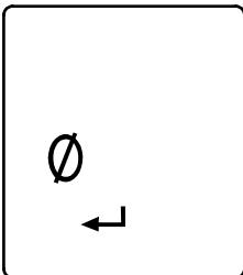
在气体读数模式下按1次 键，仪器进入调零/标定模式。在此模式下，屏幕上仅显示图标“”和“”，在此调零/标定模式下，按 键即开始调零。此时，屏幕显示“”和“”图标以及氧气传感器的标定值 (Span)，其他传感器显示0。完成此步骤后，仪器自动回到气体读数模式，若仪器未设置密码保护，屏幕显示“”图标。此时按 键，可使仪器开始对其余的传感器进行标定。更多说明，请参阅仪器调零/标定一节。
