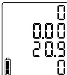
一旦仪器进入气体读数模式后，就开始对全部四种气体（ $O_2$ ,  $CH_4$ , CO,  $H_2S$ ）或其中的几种进行连续不间断的检测，并且实时更新液晶显示屏上的检测数据。在屏幕的左下角还有一个电池电量指示标志，用以提醒用户电池的电量状况。当电池电量减少时，图标的阴影部分也会随之减少。如果上述任何一种气体的浓度超过了低浓度或高浓度报警设定值（包括STEL/TWA报警设定值），仪器就会发出报警。在报警状态下，仪器按一定频率发出低频蜂鸣（低浓度报警），高频蜂鸣（高浓度报警），光报警以及振动报警。当气体浓度低于报警设定值时，仪器将返回到气体读数模式。在气体读数模式下，还可以通过按④键进入另外4个模式。
