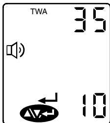
这是第三个设置屏幕页面。屏幕上显示“TWA”，“ $\square\triangleright$ ”，“ $\leftarrow$ ”和“ $\text{AV}$ ”图标，以及两种气体的TWA报警设定点。如果不需要任何改变，按 $\uparrow$ 键前进至下一屏。如果需要改变数值，按 $\downarrow$ 键。此时，屏幕上第一个TWA报警设定值将闪动。按 $\uparrow$ 和 $\downarrow$ 键调整数值。设置完毕后按 $\leftarrow$ 键选择设置下一个TWA报警值。重复该步骤直至完成两个TWA报警设定点的设置。当2个TWA设置全部完成后，屏幕上会一直出现“TWA”，
