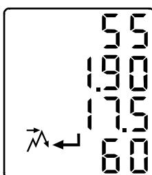
在气体读数模式下，按2次 键即可前进至峰值显示模式。在此模式下，屏幕将显示有毒气体和可燃气体传感器所测得的峰值气体浓度读数，氧气传感器测得的最低气体浓度值以及“”和“”图标。按 键复位所有的峰值为当前的读数。
