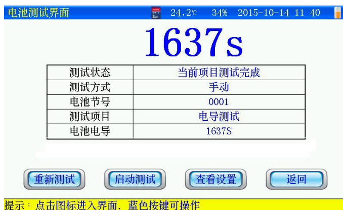
图 3.3.1 在极柱上同时测量电压和电导测试界面
