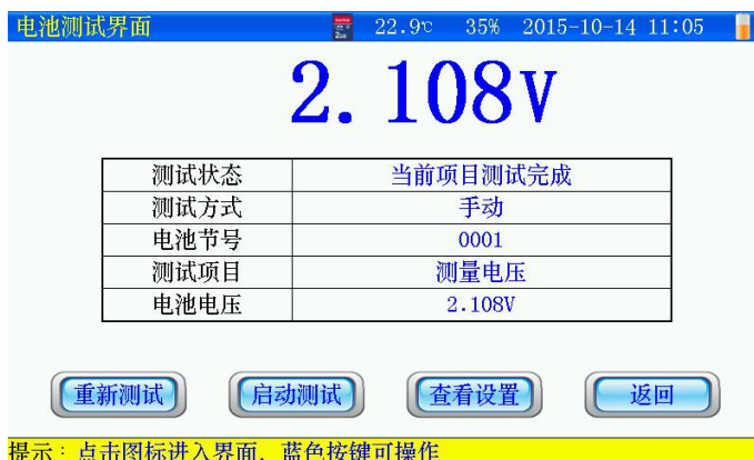
图 3.3.1-1 仅测量电压界面
