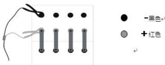
图 2.2.2 极柱测量连接方式
