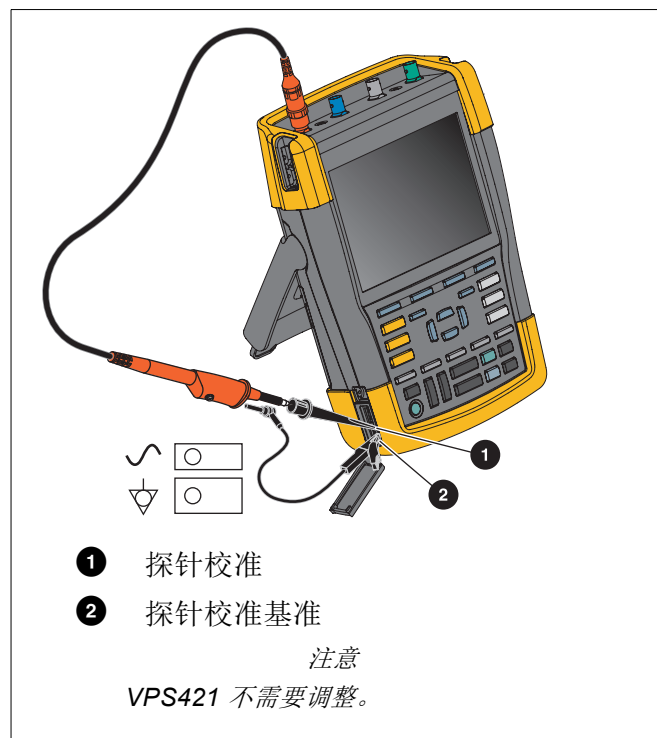
图 48. 电压探针调整
