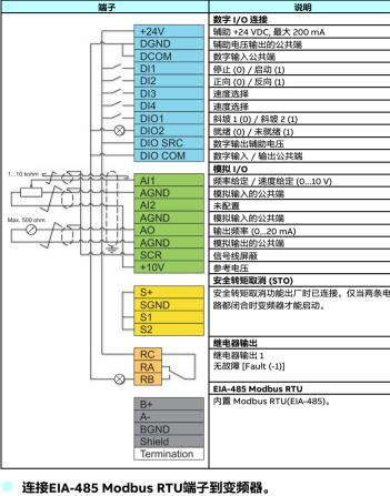
将现场总线连接到BMIO-01模块上的 EIA-485 Modbus RTU端子(该端子连接到变频器的控制单元)。连接图如下所示。
