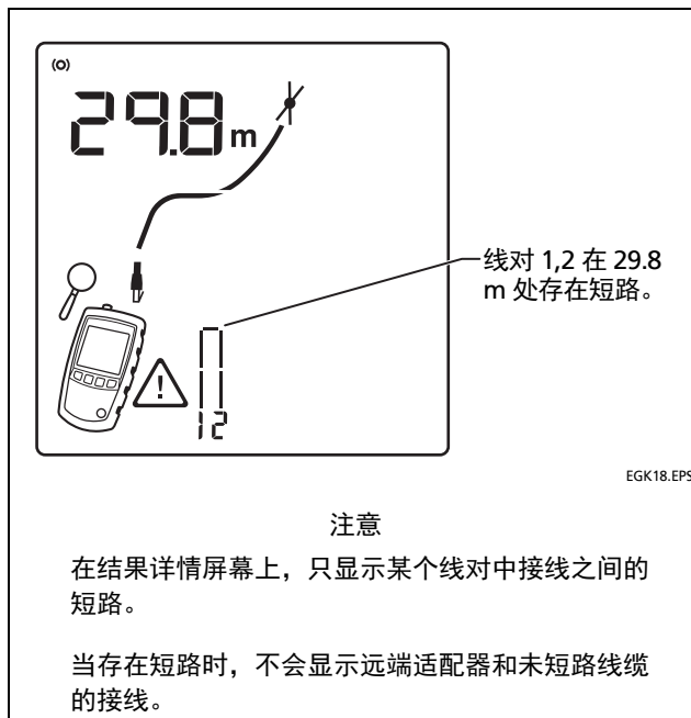
图 17. 短路详情（所示为 MicroScanner 2 屏幕）
