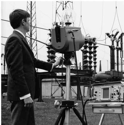
1969 : Thermovision 661 型。这款热像仪重量大约在 25 千克左右，示波器重 20 千克，三脚架重 15 千克。操作员还需要一个 220 VAC 的发电机组，以及一个装有液氮的 10 升的液罐。在示波器的左边，可以看到 Polaroid 配件（6 千克）。
