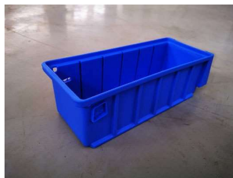
3号样品跌落试验：试样外观无异常。
