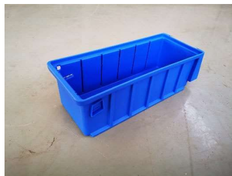
2号样品跌落试验：试样外观无异常。
