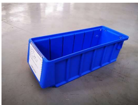
3号样品跌落试验：试样外观无异常。
