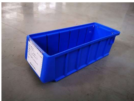
2号样品跌落试验：试样外观无异常。
