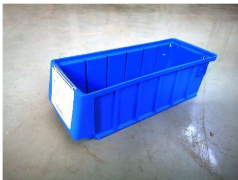
1号样品压力试验：试样外观无异常。
