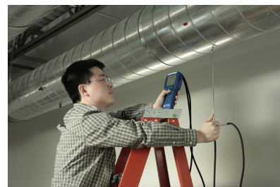
管道截面法测风量: 毕托管
