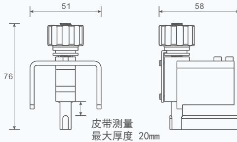
皮带张力仪测量头尺寸(单位: mm)
