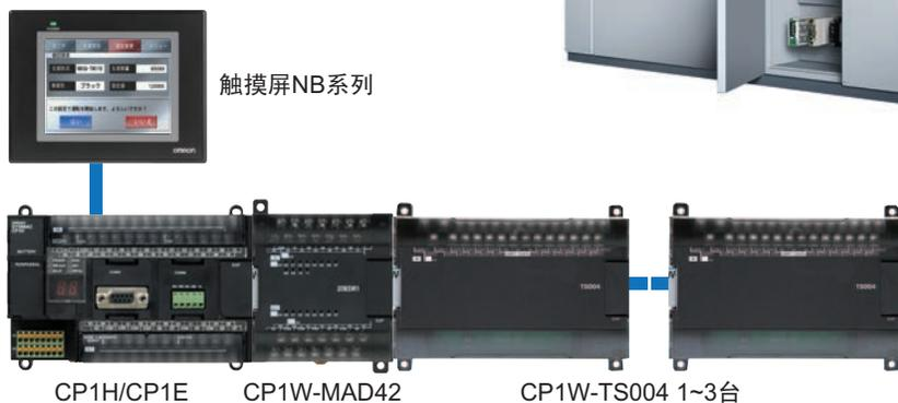
通过多点温度模块, 以及多点混合模拟量模块实现多点温度, 模拟量控制实现低价化。
