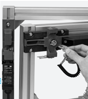
如果滑动手柄为打开状态, 无论螺线管通电与否, 均可拔出闭锁钥匙。
