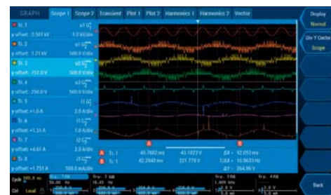
在两个波形页面都可显示8个信号的采样值
