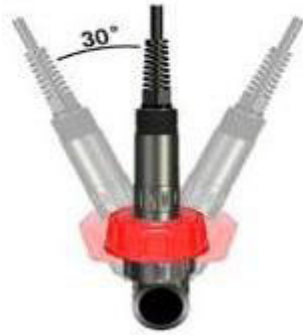
中间 1 1/4" NPT 直管螺纹固定； 直立安装或斜向安装不大于 30 度倾角 工作正常
