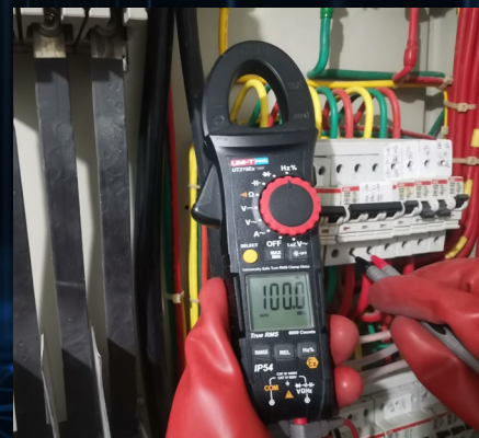
频率档误测380V电压
