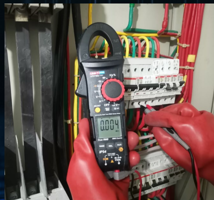
二极管档误测380V电压
